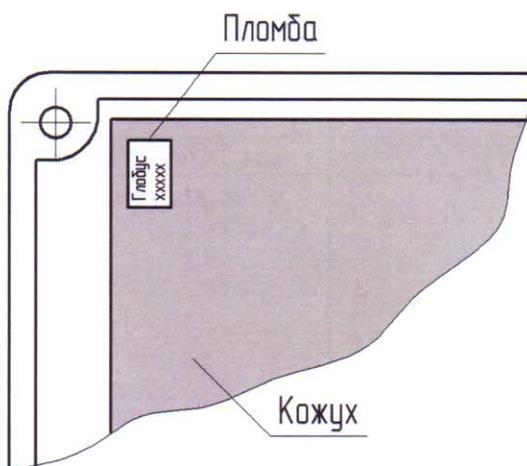
Рисунок 2. Место установки пломбы на кожухе, закрывающем плату электронного блока расходомера
