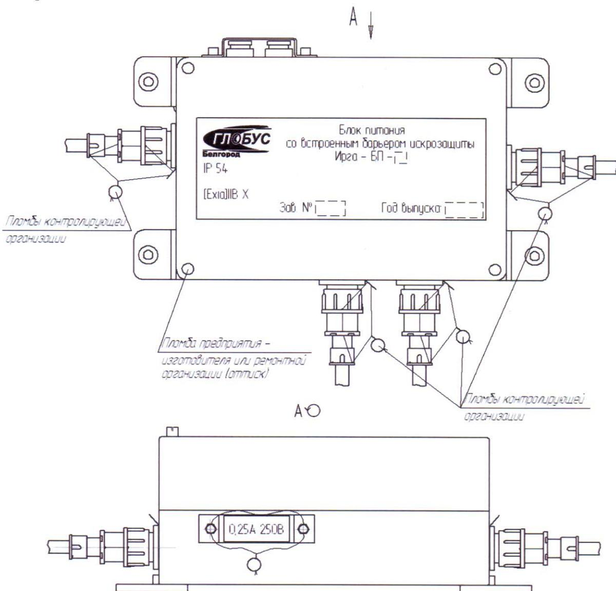
Рисунок 3. Место установки пломб на верхней крышке блока питания
